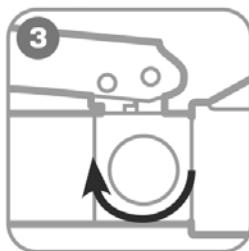
**Поверните винт сброса давления в положение «Закрыть»**
