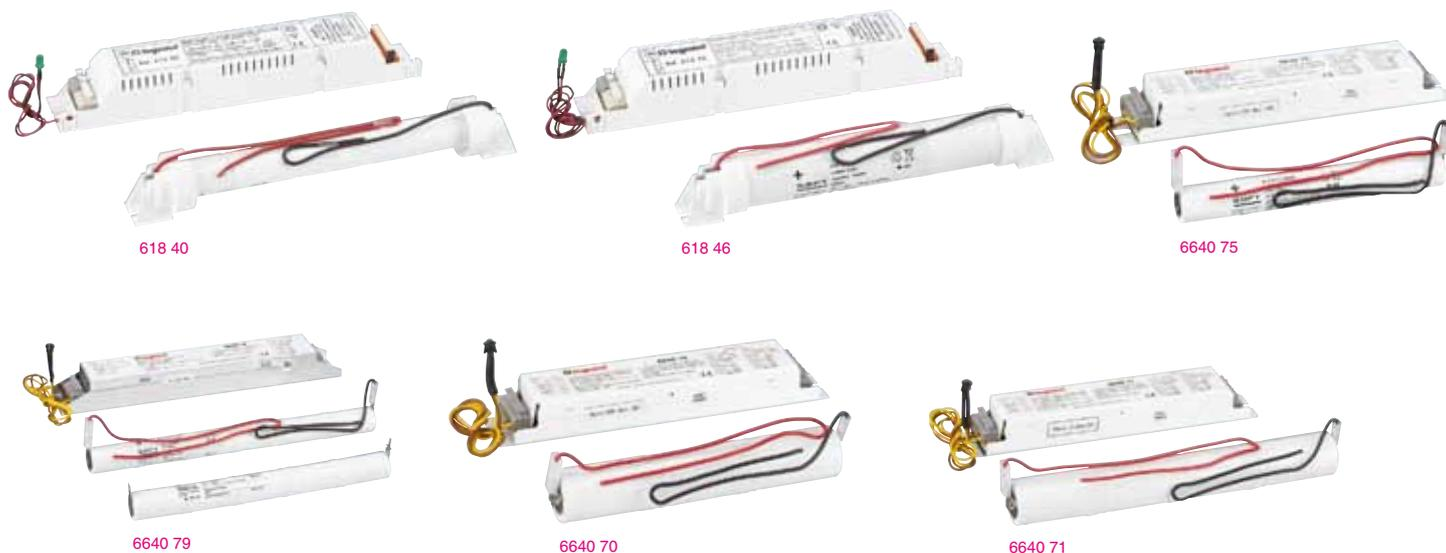
Комплект блока аварийного питания позволяет сделать из обычного люминесцентного светильника источник эвакуационного освещения, который включается при отключении сетевого питания. В комплект входят плоский инвертор / зарядное устройство и аккумулятор. Комплект совместим с магнитными и большинством электронных пускорегулирующих аппаратов (ПРА).
